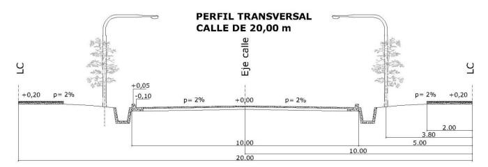
En todos los casos, cuando las calles no vayan a ser pavimentadas, la calzada deberá quedar terminada con base estabilizada compactada de las características indicadas más adelante en los lineamientos de pavimentos, y enripiado de 3 cm de espesor mínimo con un tamaño máximo de agregado grueso menor o igual a 1 pulgada.
